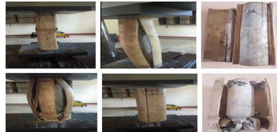
(r) Actual Compression test failures
